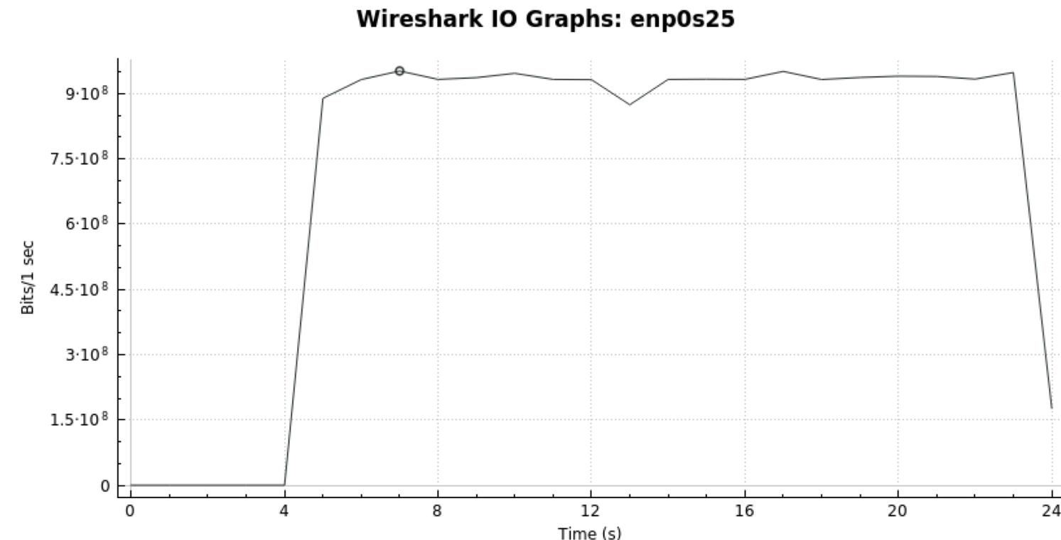
FIG 6: DATA TRANSMISSION SPEED AS MONITORED BY AN ETHERNET PACKET SNIFFER
