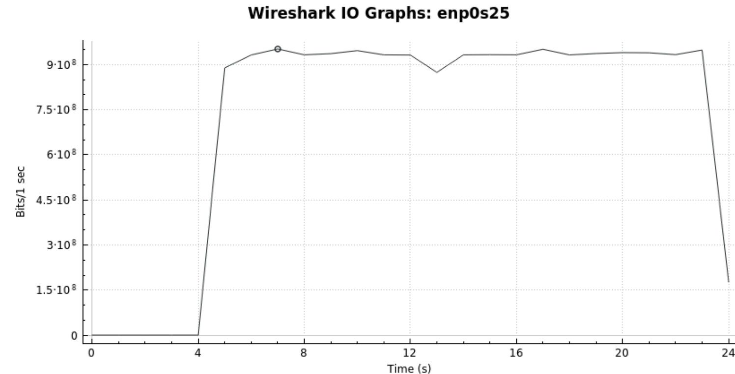
FIG 6: DATA TRANSMISSION SPEED AS MONITORED BY AN ETHERNET PACKET SNIFFER
