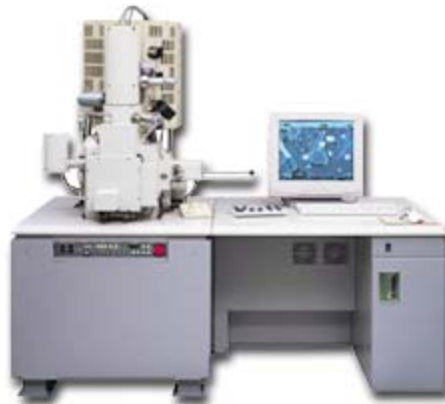
SEM – Hitachi S4800 (+ Bruker EDS)
